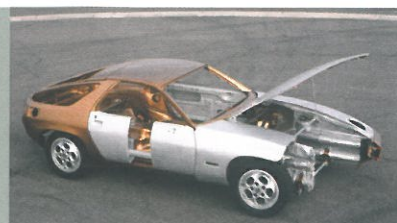
Als Typ 960 zeigt Porsche die Studie P.E.S. (Porsche Experimental Structure) eines Sicher- heitsfahrzeugs. Ihr liegt die Basis des Modells 928 zugrunde. | 1980
