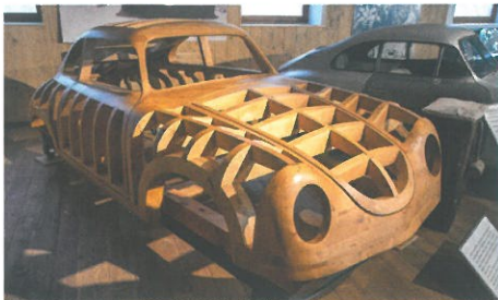
GUT HOLZ: Über solchen Modellen wurde die Alu-Karosserie des Gmünd-Coupés gedengelt
